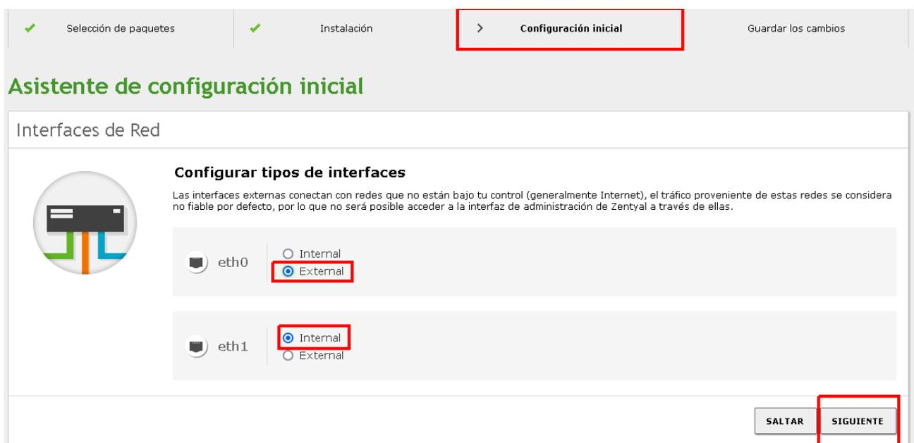
Luego de éste paso, debemos configurar las interfaces WAN y LAN del Servidor Gateway.
