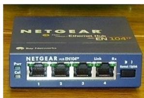
Un **concentrador** es un dispositivo que permite centralizar el cableado de una red. También conocido con el nombre de *hub*.
