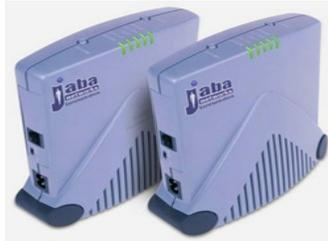
Un **puente o bridge** es un dispositivo de interconexión de redes de ordenadores que opera en la capa 2 (nivel de enlace de datos) del modelo OSI. Este interconecta dos segmentos de red (o divide una red en segmentos) haciendo el pasaje de datos de una red para otra, con base en la dirección física de destino de cada paquete.
