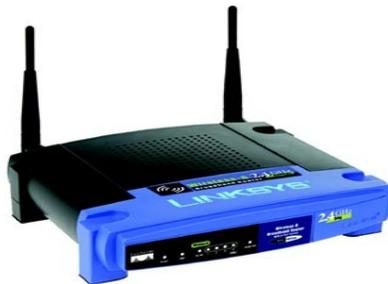
En español, enrutador o encaminador. Dispositivo de **hardware** para interconexión de redes de las computadoras que opera en la capa tres (nivel de red)
