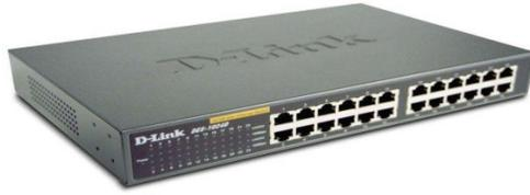
Un **switch** (en castellano "conmutador") es un dispositivo electrónico de interconexión de redes de ordenadores que opera en la capa 2 (nivel de enlace de datos) del modelo OSI (*Open Systems Interconnection*). Un conmutador interconecta dos o más segmentos de red, funcionando de manera similar a los puentes (bridges), pasando datos de un segmento a otro, de acuerdo con la dirección MAC de destino de los datagramas en la red.
