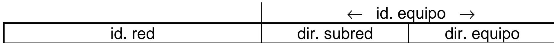
Por ejemplo, la dirección de clase B 158.108 puede utilizar su tercer byte para identificar la subred: 158.108.1.X , 158.108.2.X , ... donde X es una dirección de equipo que va de 1 a 254.
