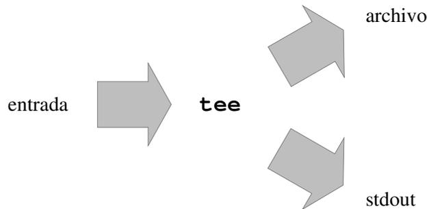
Figura 5.1: Esquema de funcionamiento de la orden `tee`.
