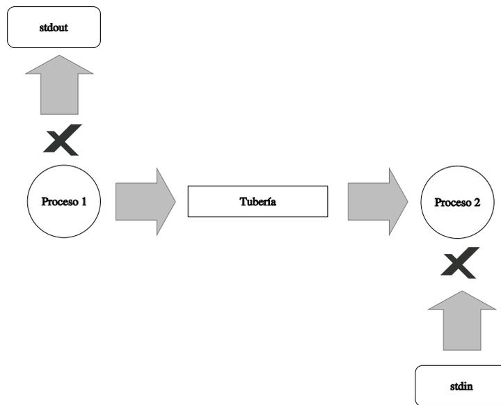
Figura 4.4: Comunicación entre dos procesos empleando una tubería.
