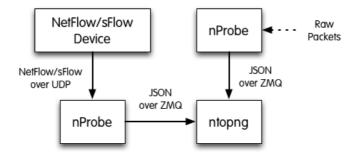
Figure 1 - ntopng/nprobe setup
